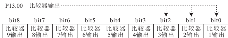
图 6-12-1 指示比较器输出结果
